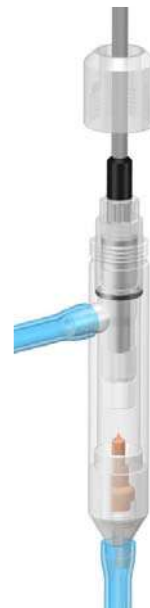
Рис. 3.10. Фиксация ASrO_2 в измерительной камере
